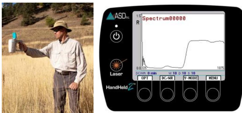
Obr. 2.15 Ukázka měření spektra odrazivosti přístrojem HandHeld2
